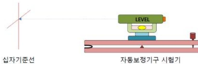
그림 6. 자동 레벨의 자동보상기구의 작동 시험장치
