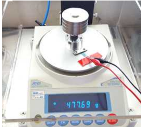
그림 5. 필름형 힘센서 압저항 특성 측정 장치 예
