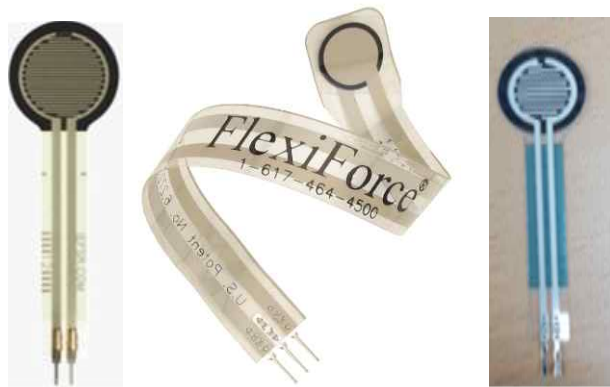
그림 1. 시중에 많이 사용되는 대표적인 필름형 힘센서들 (좌측부터, FSR, Flexiforce, PSR)
