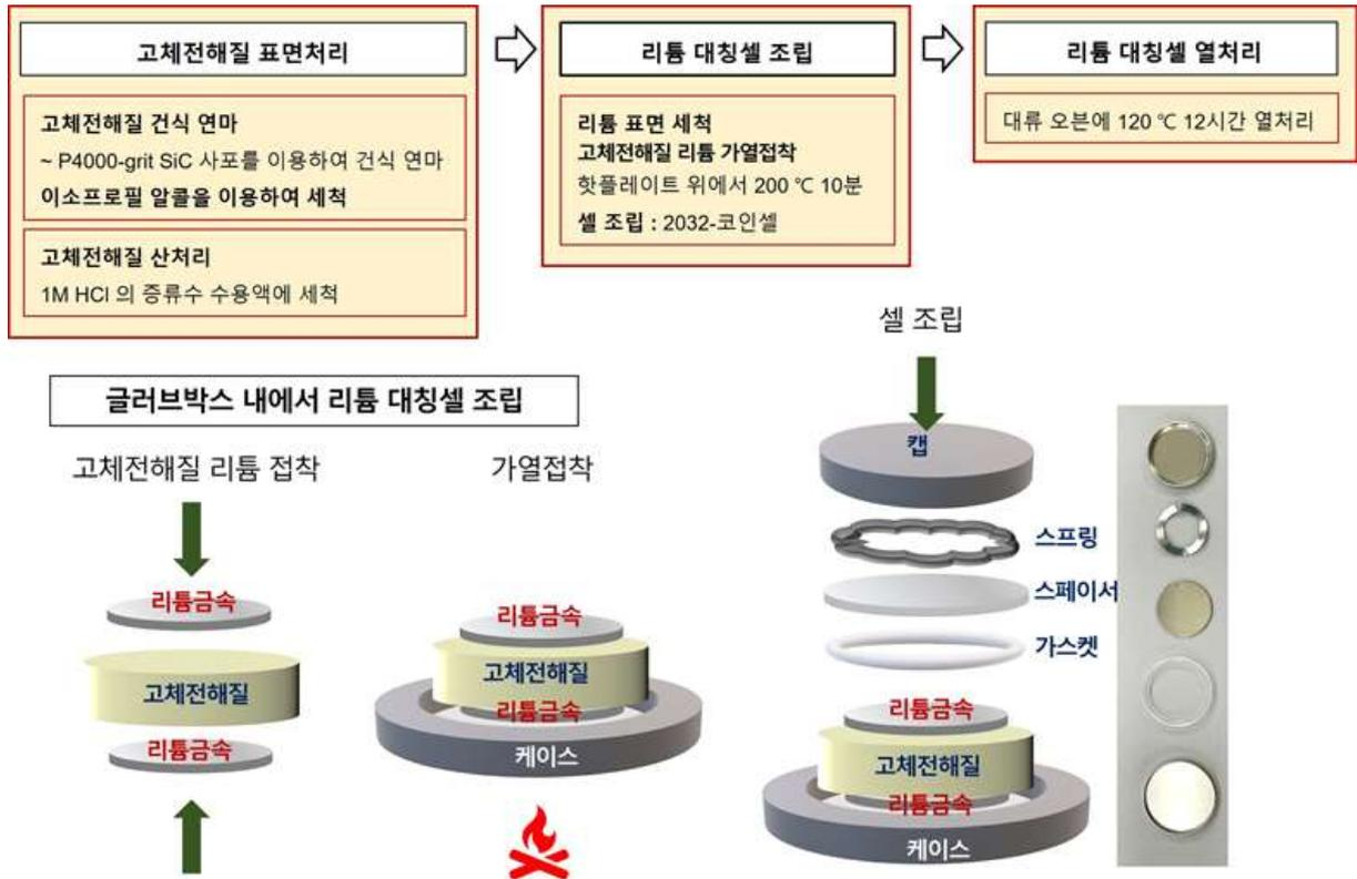
그림 4. 리튬 음극 적합성 평가를 위한 리튬 대칭셀 조립 과정
